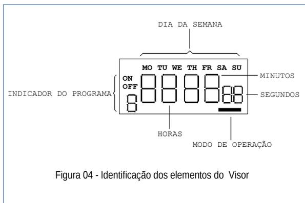
Figura 04 - Identificação dos elementos do Visor
