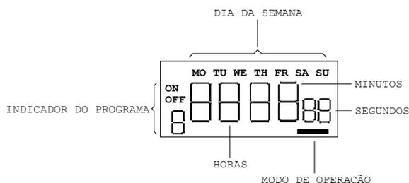
Figura 04 - Identificação dos elementos do Visor
